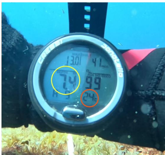
Figura 2. Mergulhador mostrando no início da filmagem o computador de mergulho com dados de profundidade (círculo amarelo) e temperatura (°C) (em vermelho) (Foto: Lucas Nunes).
